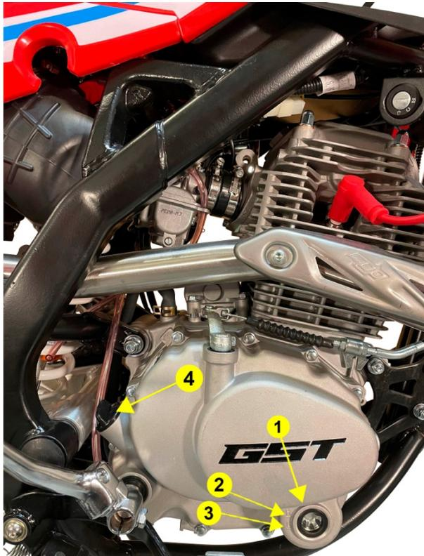
Le niveau d'huile moteur doit être vérifié avant chaque utilisation. Vous devez le vérifier grâce à la fenêtre placée sur le carter droit de la moto, comme sur l'image (1). Voici les étapes à suivre :
